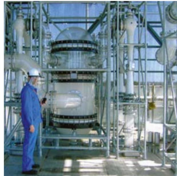
化学装置製造: 巨大技術装置に適した高い寸法精度を持つデュラン®ガラス管
